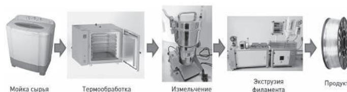
**Рис. 1. Технологическая схема процесса получения филамента из вторичного ПЭТ.**
