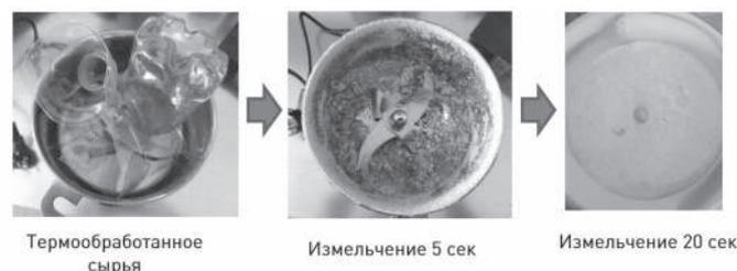
Рис. 2. Характер измельчения материала.
