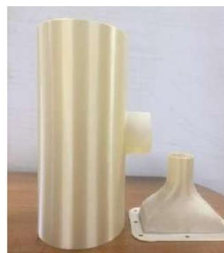
Разработанные в КБГУ суперконструкционные полимеры и изделия, напечатанные из них, для магистрального самолета MC 21
