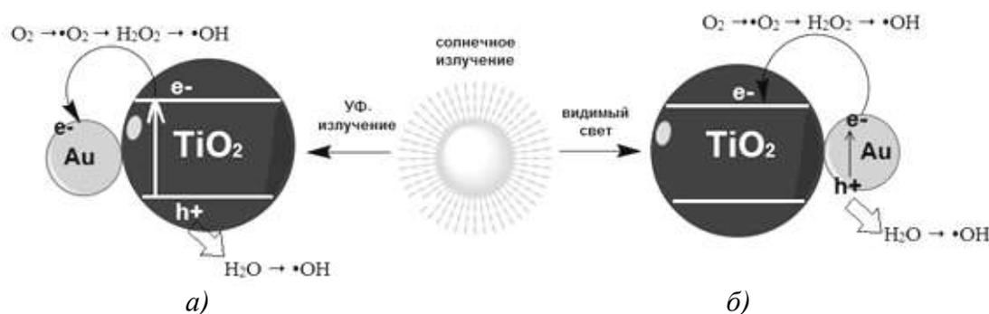
Рис. 2. Процессы, протекающие на поверхности  $TiO_2$ , модифицированного НЧ золота, при воздействии УФ- (а) и видимым (б) светом
