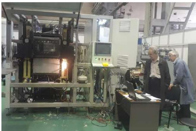
Установка послойного лазерного спекания «Эльбрус»
