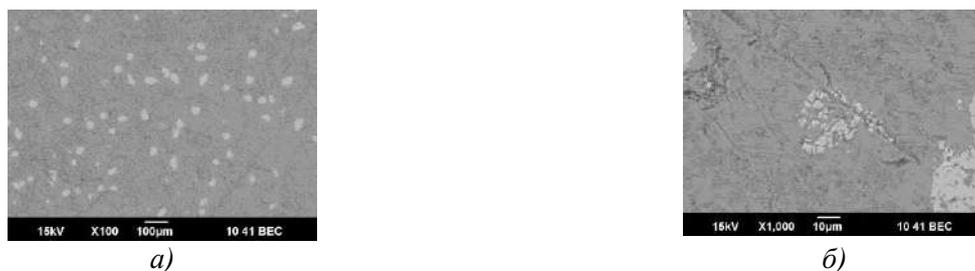
Рис. 5. СЭМ изображение поверхности шлифов образца Al +3 %  $V_2O_5$  после отжига в воздушной среде в течение 1 часа при 1173 К
