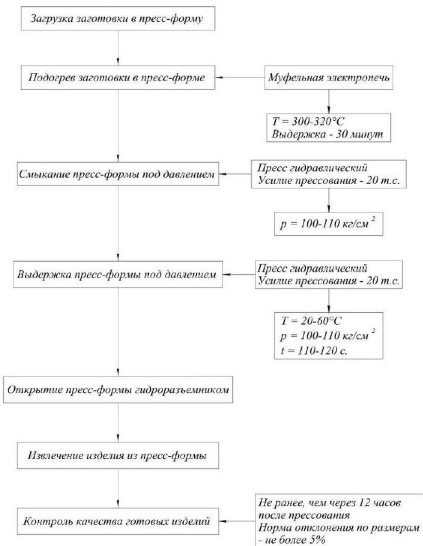
Рис. 5. Технологический регламент получения опорного изолятора объемной штамповкой
