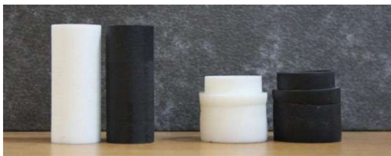
Рис. 3. Фотография заготовок (слева) и изделий из заготовок диаметром 18 мм (справа).
