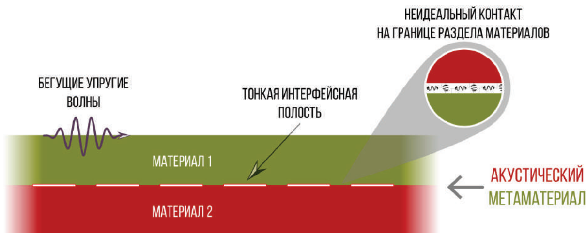
Рисунок 1. Геометрия слоистого волновода с интерфейсными полостями
